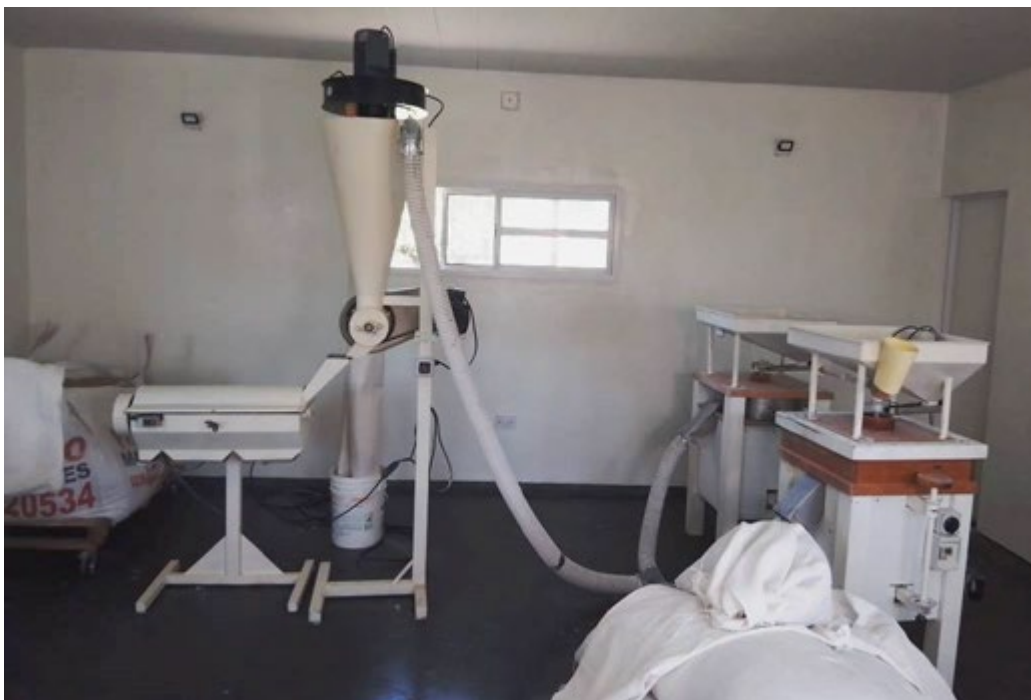
Figura 2: Molino a piedra de grano entero.
