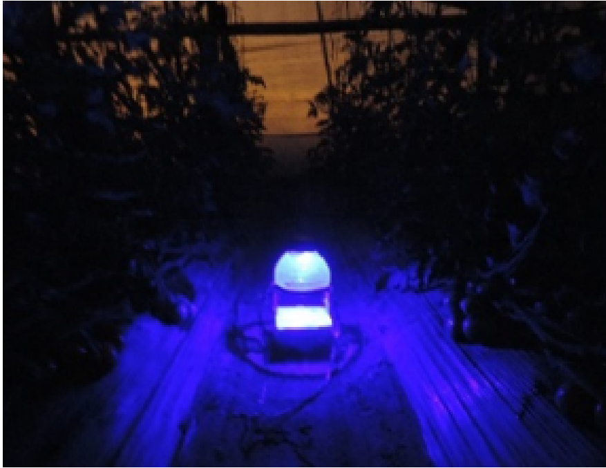
Figura 3: Trampa de feromonas con luz LED con panel solar.
